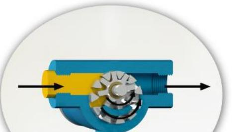
Yandaki renkli kısım sıvının pompa gövdesindeki emiş ağzı alanına, rotor dişlisi ve avare dişlisi dişleri arasındaki dişli
