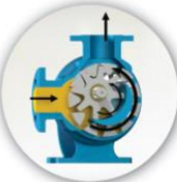
"Dişli içinde dişli" prensibinde çalışan dişliler ile pompa içinde sıvının ilerleyişine dikkat edin. Aynı zamanda, pompa kapağı üzerindeki hilal şeşinin sıvayı nasıl böldüğüne ve emiş ile boşaltma ağızları arasında bir keçe (conta) gibi vazife gördüğünü dikkat ediniz.
