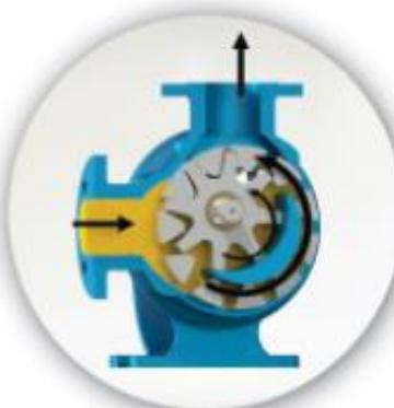
Bu resim pompanın iç kısmının dolup sıvının boşaltma ağızı alanına itilmesinden hemen önceki durumunu göstermektedir. Avare ve rotor dişlilerinin dizaynının sıvı için nasıl bir kapalı cep oluşturduğuna ve bunun tam bir hacim kontrolü sağlanması nasıl garantilediğine dikkat ediniz.
