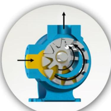
"Dişli içinde dişli" prensibinde çalışan dişliler ile pompa içinde sıvının ilerleyişine dikkat edin. Aynı zamanda, pompa kapağı üzerindeki hilal şeklinin sıvayı nasıl böldüğüne ve emiş ile boşaltma ağızları arasında bir keçe (conta) gibi vazife gördüğünə dikkat ediniz.
