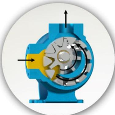
Yandaki renkli kısım sıvının pompa gövdesindeki emiş ağızı alanına, rotor dişlişi ve avare dişlişi arasındaki dişli boşlukları alanına girişini gösterir. İki siyah ok pompanın dönüş ve sıvının ilerleyişini gösterir.
