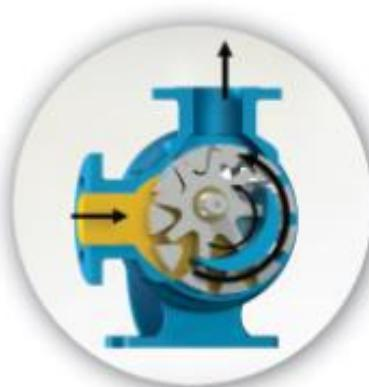
"Dişli içinde dişli" prensibinde çalışan dişliler ile pompa içinde sıvının ilerleyişine dikkat edin. Aynı zamanda, pompa kapağı üzerindeki hilal şeklinin sıvayı nasıl böldüğüne ve emiş ile boşaltma ağızları arasında bir keçe (conta) gibi vazife gördüğünne dikkat ediniz.
