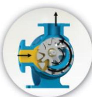
Yandaki renkli kısım sıvının pompa gövdesindeki emiş ağızı alanına, rotor dişlişi ve avare dişlişi arasındaki dişli boşlukları alanına girişini gösterir. İki siyah ok pompanın dönüş ve sıvının ilerleyişini gösterir.
