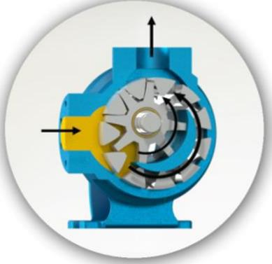
Yandaki renkli kısım sıvının pompa gövdesindeki emiş ağızı alanına, rotor dişlisi ve avare dişlisi dişleri arasındaki dişli boşlukları alanına girişini gösterir. İki siyah ok pompanın dönüş ve sıvının ilerleyişini gösterir.
