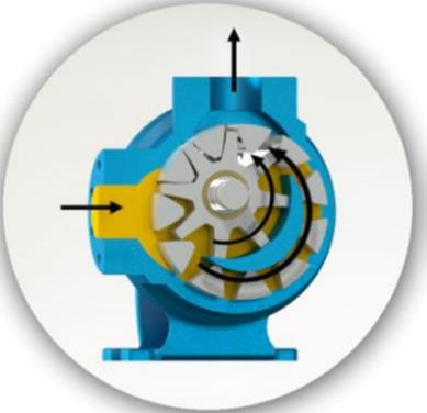
Bu resim pompanın iç kısmının dolup sıvının boşaltma ağızı alanına itilmesinden hemen önceki durumunu göstermektedir. Avare ve rotor dişlilerinin dizaynının sıvı için nasıl bir kapalı cep oluşturduğuna ve bunun tam bir hacim kontrolü sağlanmasını nasıl garantilediğine dikkat ediniz.
