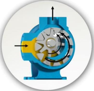
"Dişli içinde dişli" prensibinde çalışan dişliler ile pompa içinde sıvının ilerleyişine dikkat edin. Aynı zamanda, pompa kapağı üzerindeki hilal şeklinin sıvıyı nasıl böldüğüne ve emiş ile boşaltma ağızları arasında bir keçe (conta) gibi vazife gördüğüne dikkat ediniz.
