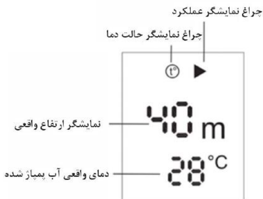
شکل-۷: تصویر پنل کنترلی الکتروپمپ به هنگام فعال شدن وضعیت کنترل دما
